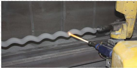
**Placare rotori cu carburi de tungsten prin procedeul HVOF (high velocity oxygen fuel) avand ca scop:**
